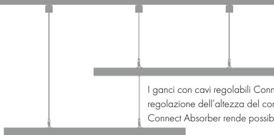
I ganci con cavi regolabili Connect consentono una flessibilità nella regolazione dell'altezza del controsoffitto, mentre l'ancoraggio tramite Connect Absorber rende possibile l'installazione di livelli multipli.
